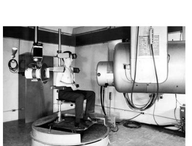
La deuxième génération pouvait utiliser des photons de faible énergie, avait une taille plus petite et un isocentrique avec un montage mouvement de rotation de 360 ° du portique.
