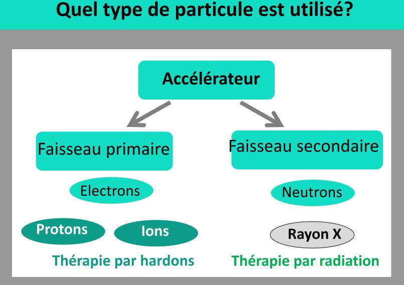
En cas de neutrons et de rayons X, le système de portique concentre le faisceau primaire sur une cible où des particules de haute énergie sont produites à la suite des collisions
