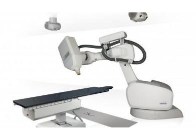
Plusieurs accessoires de modification du faisceau sont disponibles. Des systèmes d'imagerie sont montés sur Linac meilleur pour un positionnement du patient. Le système est entièrement contrôlé par ordinateur.
